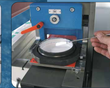
Encrier/encrier raclant "ClipLock®" avec couvercle
