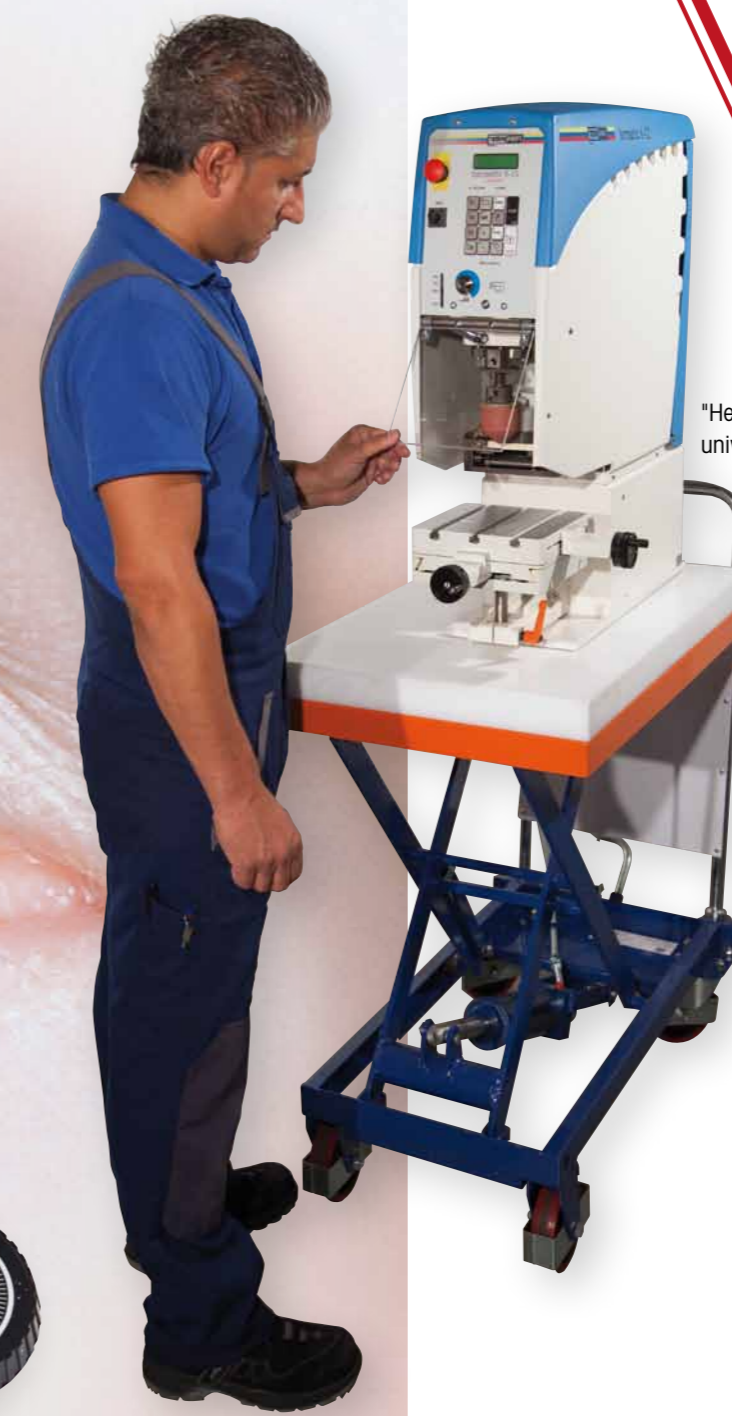
Système d'enlèvement des encres résiduelles (nettoyage du tampon)
