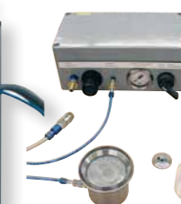
Appareil de commande du vacuum + encrier/encrier raclant avec piston + soufflet
