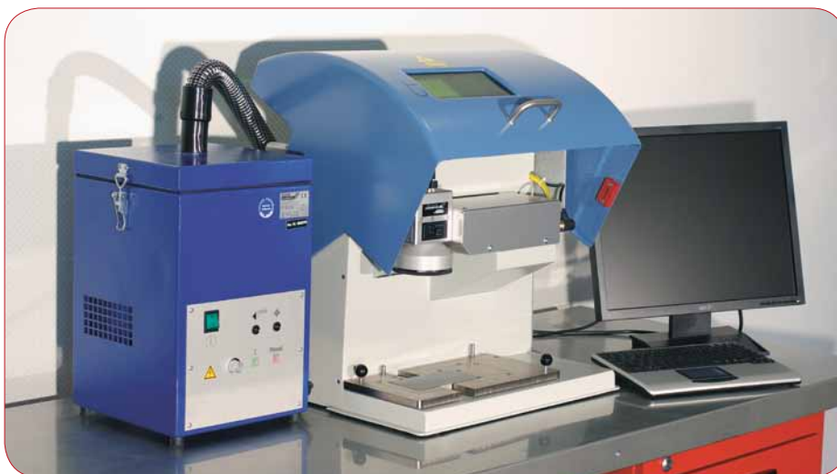
Laser de table à clichés "CT-60" avec groupe d'aspiration et de filtration fourni
