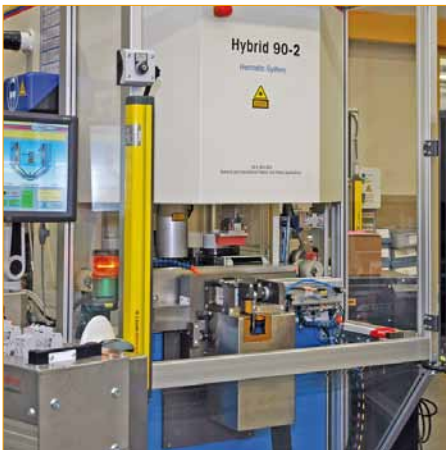
Image : La machine de tampographie à deux couleurs "Hybrid 90-2" est utilisée pour l'impression sur deux côtés
