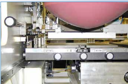
III.: TS 450/41 Machine de référence, version 2 encres, impression sur antennes paraboliques
