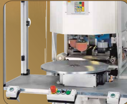
Plato rotativo "T2" para la alimentación de piezas
