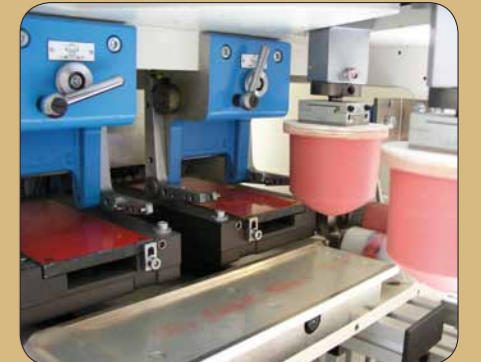
"V-DUO" con sistema de limpieza de tampones
