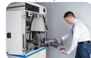
Unidad de láser integrada para la producción de clichés
