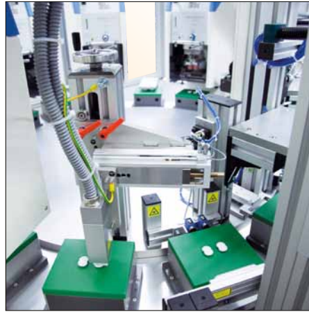
La estación de pre-tratamiento garantiza una óptima adhesión de la tinta
