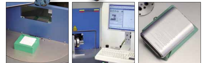
Abb.: Detailsicht Drehteller Abb.: Detailsicht Arbeitsplatz Abb.: Beispiel Lasergravur auf Aluminium
