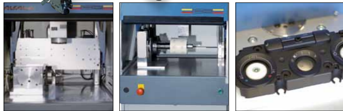
Abb.: Arbeitskammer mit Teilapparat Abb.: automatische Schwenktür - geöffnet Abb.: Beispiel Tag & Nacht Design
