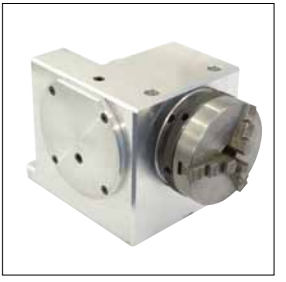
Teilapparat mit Spannkranzfutter Übersetzung 10:1
