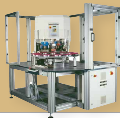
"V-130 DUO" Leistungssteigerung durch Einbau in eine "Modul 2000" -Einheit
