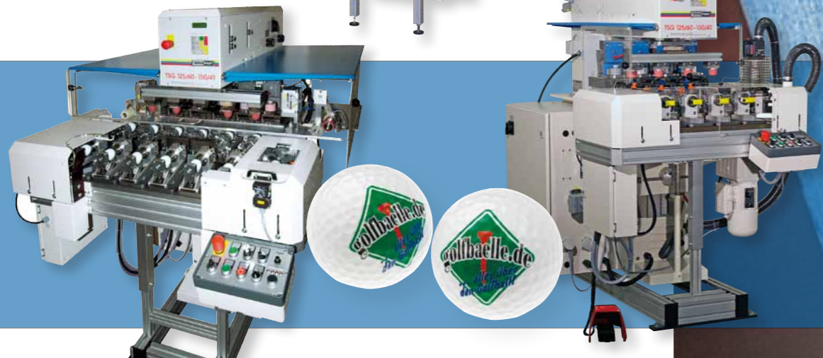
Referenz: Halbautomation zur Golfballdekoration mit 5 Farben
