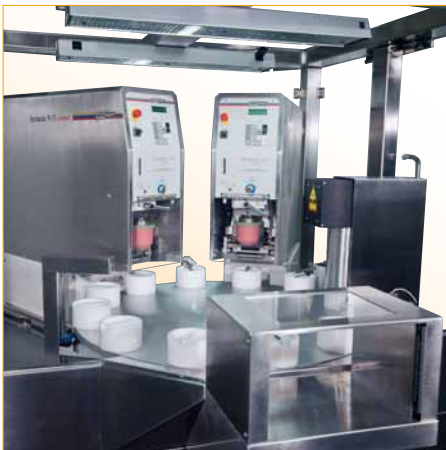
Abb.: 2x "Hermetic 9-11 universal" + Faserlaser SK 622
